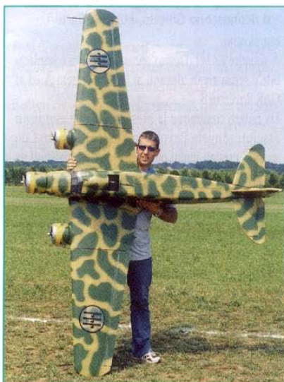
Luca Auditore con un notevole trimotore elettrico l'SM 79 (Gobbo Maledetto) motore centrale AXI 2826/10, motori laterali AXI 2820/10.
